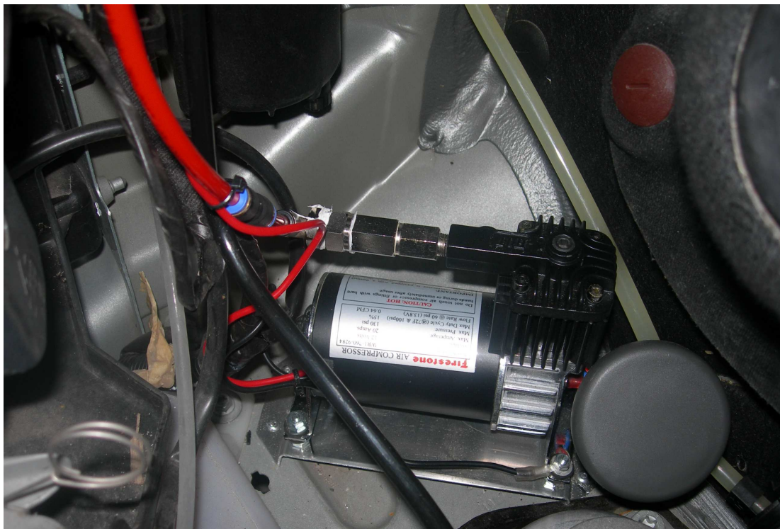
Vista del compresor instalado en el recinto motor
