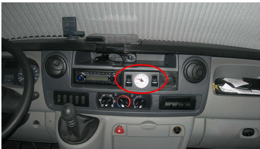
Vista del manómetro y válvulas de inflado en cabina
