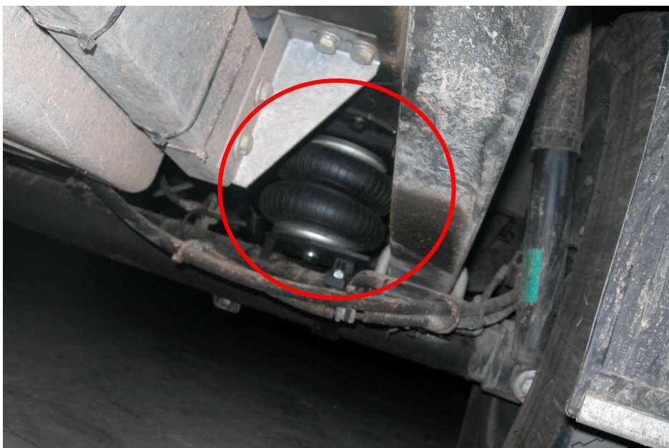
Vista del muelle neumático montado junto a la ballesta y al amortiguador
