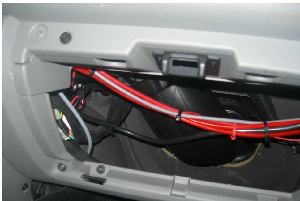
Paso de los tubos neumáticos por detrás de la guantera
